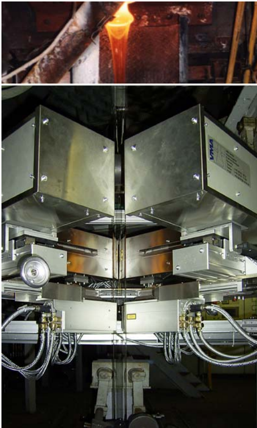
Hai máy đo đường kính trên dây chuyền thẳng đứng của Thủy tinh Borosilicat (3.3-Ảnh trên), máy đo đường kính lớn Thủy tinh Thạch anh trên máy quay chế biến ống Thạch anh(ảnh dưới)
