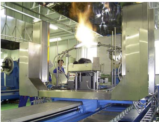
Hai máy đo đường kính trên dây chuyền thẳng đứng của Thủy tinh Borosilicat (3.3-Ảnh trên), máy đo đường kính lớn Thủy tinh Thạch anh trên máy quay chế biến ống Thạch anh(ảnh dưới)
