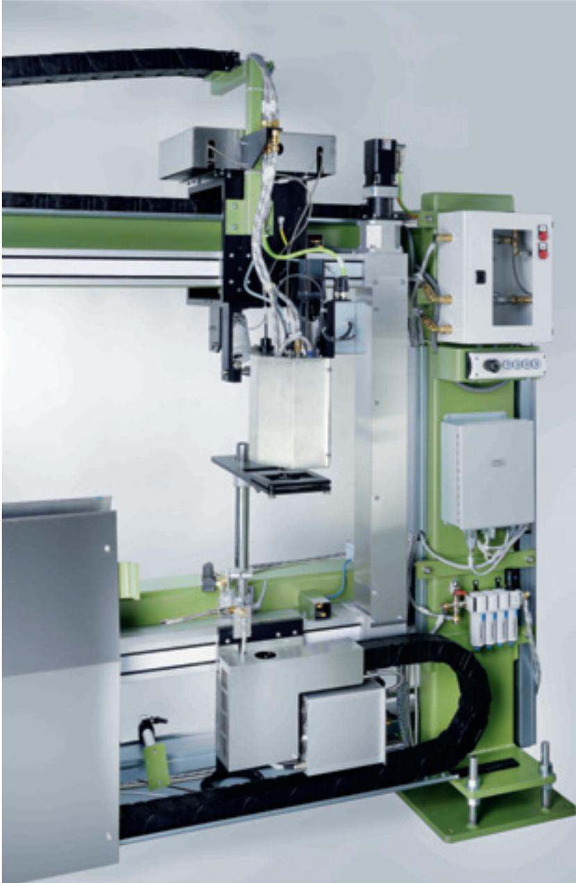
контроля качества кварцевых трубок. С помощью этой техники можно будет измерять не только диаметр и толщину стенки, но и обнаружить дефекты в стекле.
